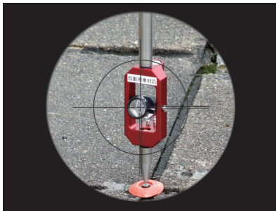
ミラー定数 0mm の場合 正対がずれると視準がずれます。
