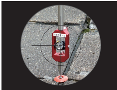
ミラー定数 -7mm の場合 正対がずれても視準がずれません。
