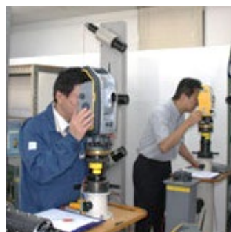
Trimble製トータルステーションの点検調整にもご利用いただけます。
